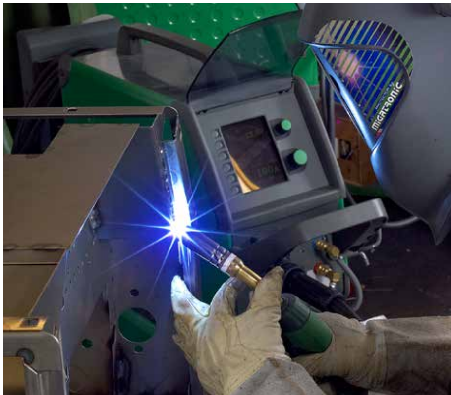
A Sigma Galaxy készülék egy nagy teljesítményű számítógéppel rendelkezik, amely másodpercenként 50 000-szer ellenőrzi a folyamatot.
