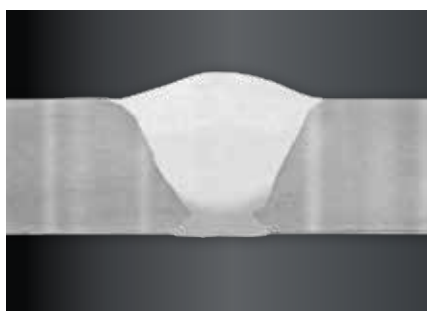
IAC gyökvarrat függőlegesen lefelé hegesztve, 10 mm-es lágyacélban; két töltővarrattal függőlegesen lefelé.
